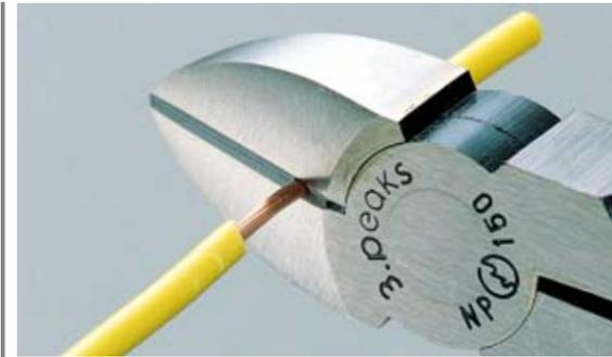
皮むき作業に便利。弱電及び電気工事関係に広く使用されています。刃部にはビニールコードの皮むき作業が容易に出来るように $\phi 1.5\text{mm}$ の穴があけてあります。
