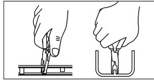
縦型タイプになっており、プラスチック成形品の深い箇所のゲートの切断に最適です。刃巾も3mm (MTC-3)、5mm (MTC-5) の2種類用意しております。
