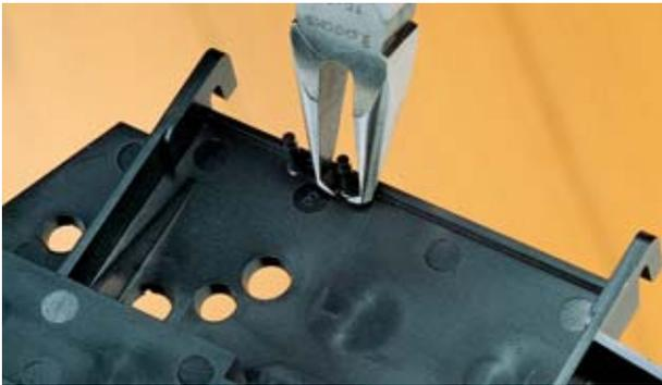
縦型タイプになっており、プラスチック成形品の深い箇所のゲートの切断に最適です。刃巾も3mm (TC-3Z)、5mm (TC-5Z)、7mm (TC-7Z)、10mm (TC-10) の4種類用意しております。TC-10以外はエラストマー成形グリップを使用しております。
