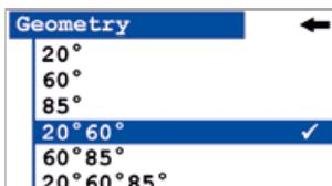
所有被选择的角度在同一个点上测量，并立即显示测量结果 - 包括：统计、差值、合格/不合格结果。
