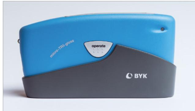
为了清楚地得到从平光到高光的整个范围内的光泽度差值，国际标准规定了三个角度。每个角度都在对应的光泽范围内进行优化测量。
