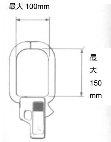
8004 型钳型电流转换器可对最大直径达 55mm 的导体, 测量达到 1000A 的交流电流。
