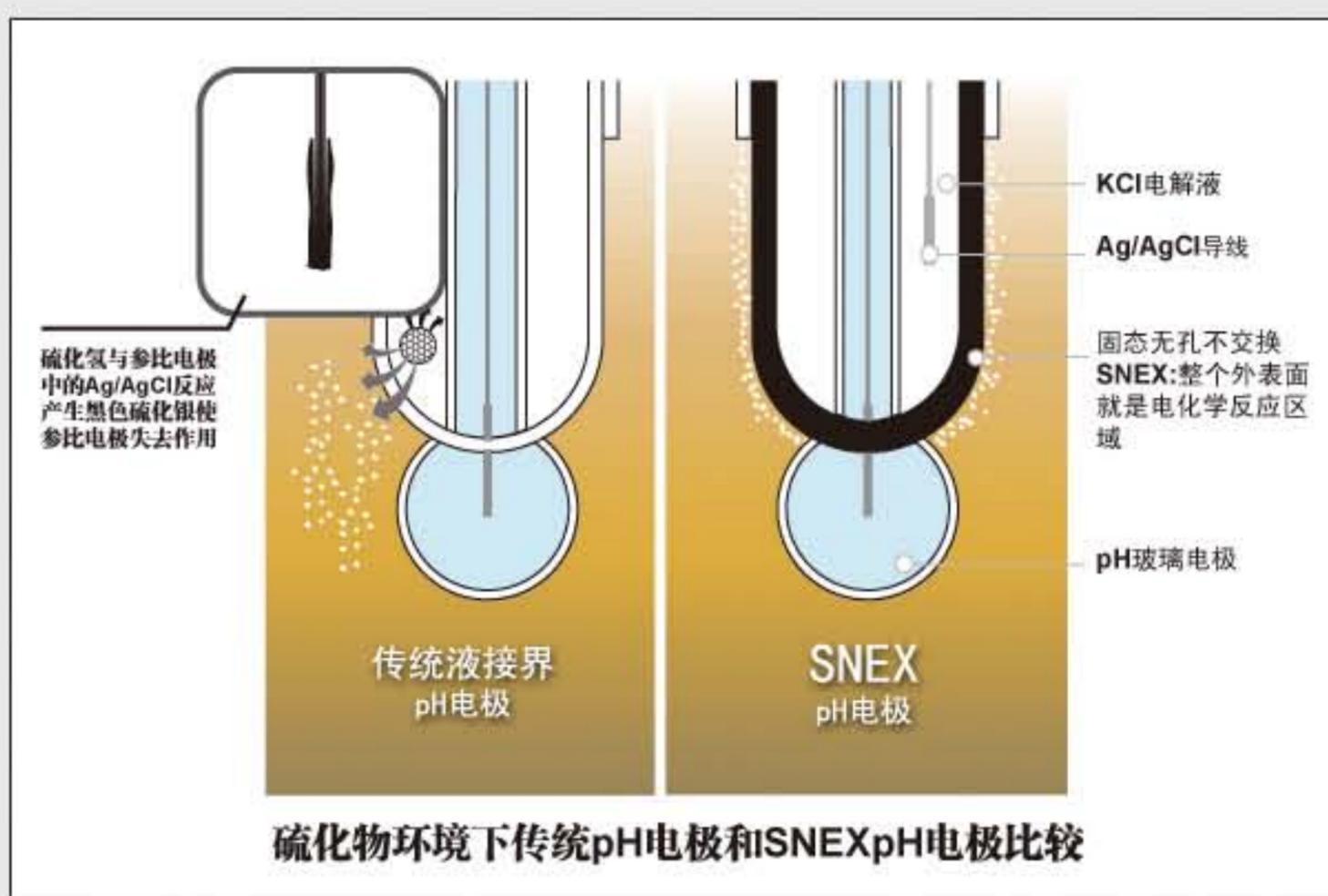
CLEAN SNEX 革命性的、创新性的 S 系列 pH 电极特别针对于传统的 pH 电极在测量硫化物，硫化氢洗涤塔，石油，天然气，强酸、强碱等环境下的测量困境。
