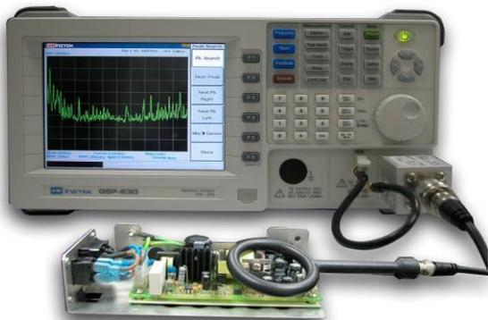
**圖十二 電磁干擾放射源的量測範例**
