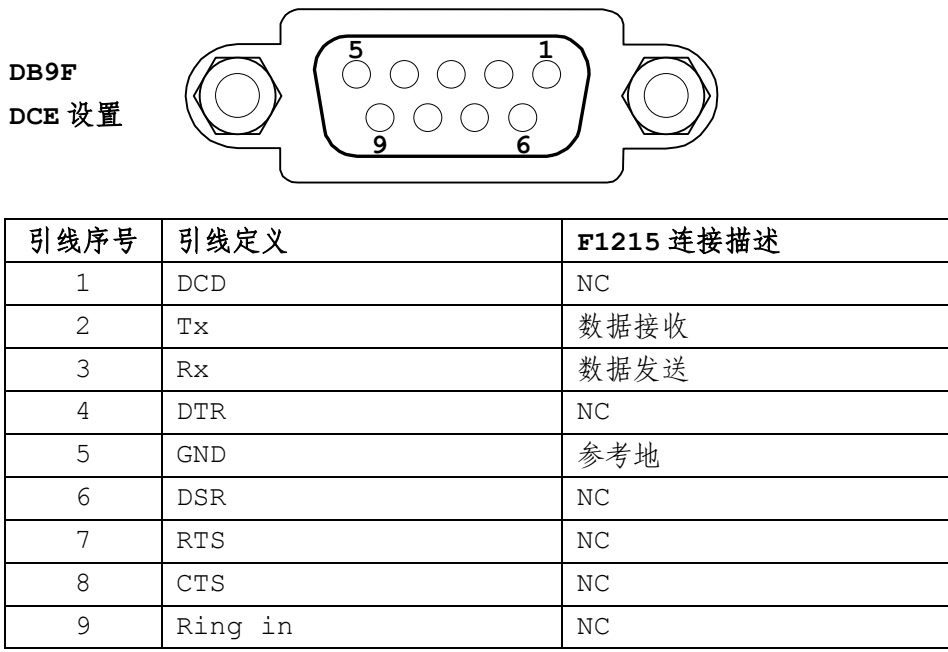
图 4-1 常用 DCE 设置 9 针连接器引线序列
