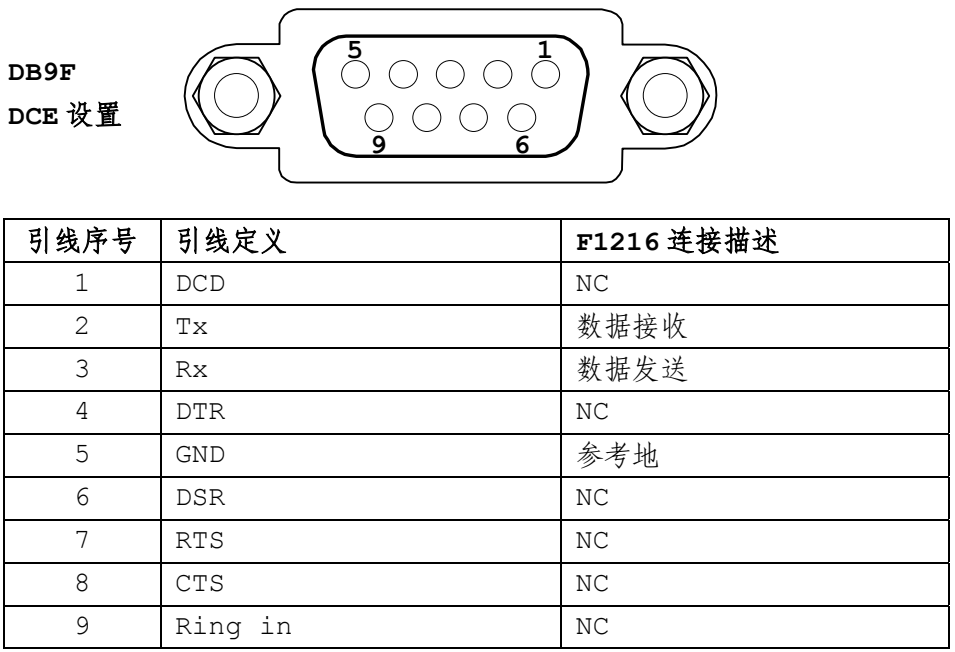
图 4-1 常用 DCE 设置 9 针连接器引线序列
