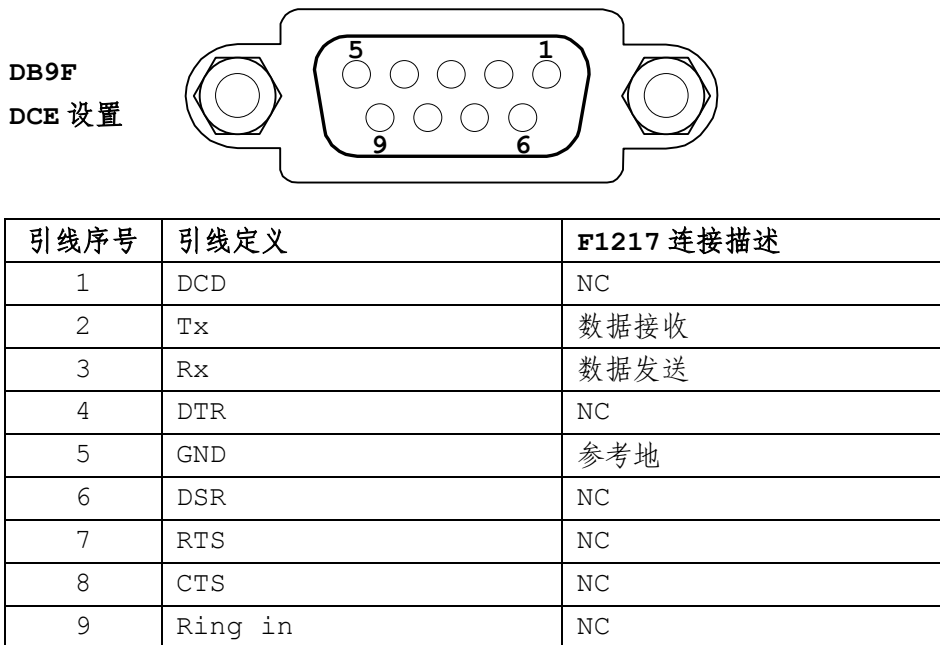
图 4-1 常用 DCE 设置 9 针连接器引线序列
