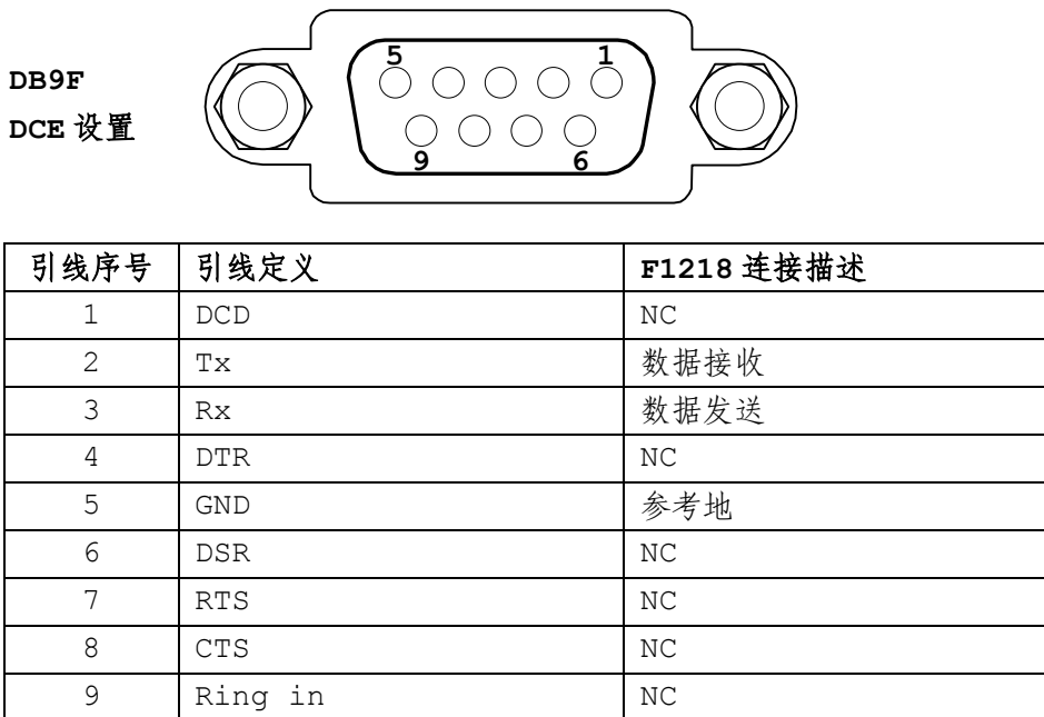
图 4-1 常用 DCE 设置 9 针连接器引线序列
