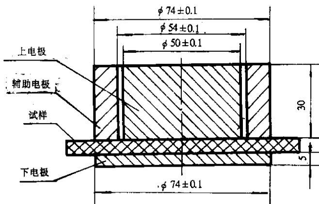
图 1 电极尺寸及其与试样的配置
