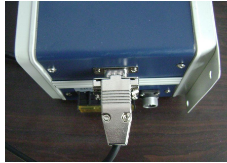
接线盒 VGA 端子与显示仪表上的 VGA 端子对接
