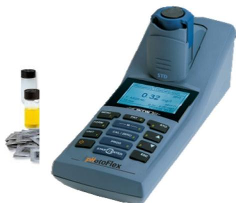
便携式光电比色计pHotoFlex STD可以在现场和实验室用于水质分析和其他常规测量：简单、舒适和低功耗。pHotoFlex系列基本型号提供6个波长，使用LED灯源，每组电池大约可测量3000组数据。
