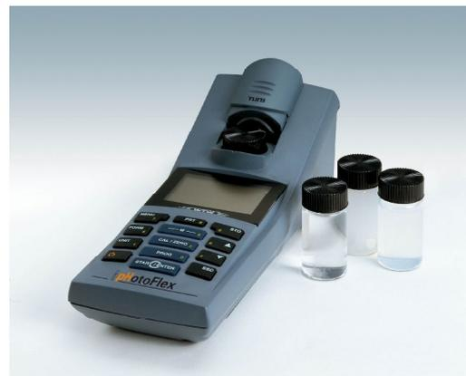
pHotoFlex Turb和pHotoFlex pH相同，但增加了一个红外光源用于90°比浊度测量，符合DIN27027/ISO7027要求，它具有实验室浊度测量的精度，结合AMCO(美国环保署)Clear®高精度标准液可用于饮用水的精确测量。
