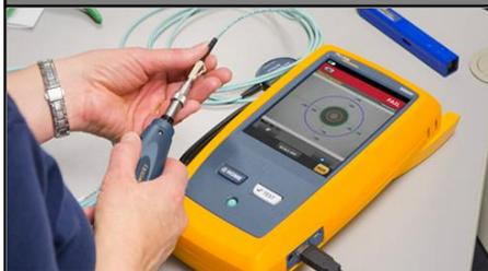
2秒自动评判结果的通过/失败，快速查找光纤端面脏污这一头号光纤故障源。检测光纤清洁度时，再也不用人工判断了，每个人都可以成为光纤测试的专家。
