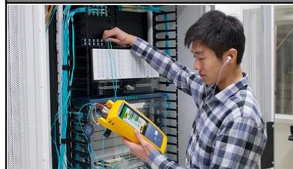
业界首款完全集成了环通量合规测试功能的仪表，保证以最高的精度进行光纤损耗的测量
