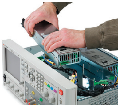
图 2. 将直流电源模块轻松安装到 N6705 直流电源分析仪主机中
