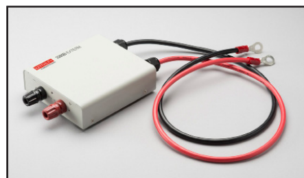
2260B-EXTERM： 扩展端口： 测试引线，0.7m(28 in.)，以及接线盒，将输出与仪器前面板或其他位置相连。仪器侧面附有磁性座。
