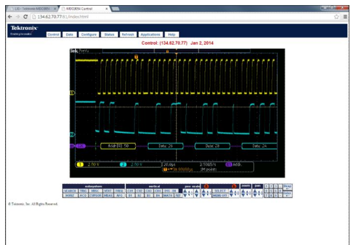
网络浏览器中的 e*Scope 显示 MDO3000 的画面。可以使用 e*Scope 保存屏幕图像、波形或设置，快速编制文档，以供日后使用。
