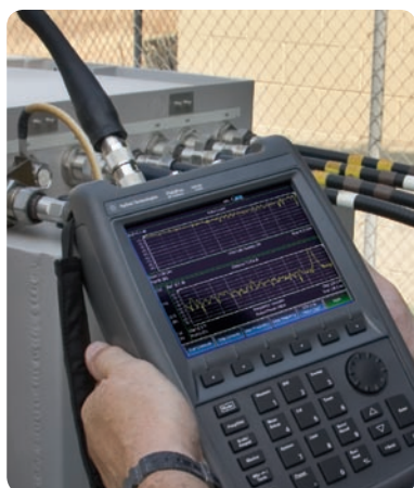
同时执行并查看回波损耗及故障点距离测试结果
