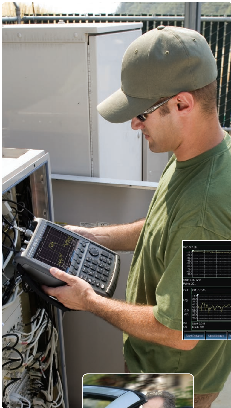
回波损耗和故障点距离 (DTF) 测试结果显示
