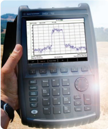
透反式显示屏即使在阳光的直射下也能很清楚地看到显示的画面
