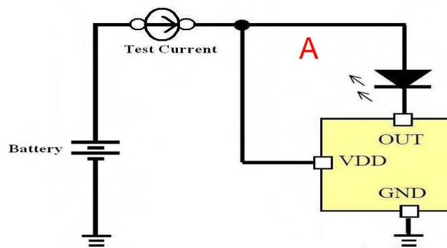
圖十四 加上 7135 穩流 IC 時測試線路圖
