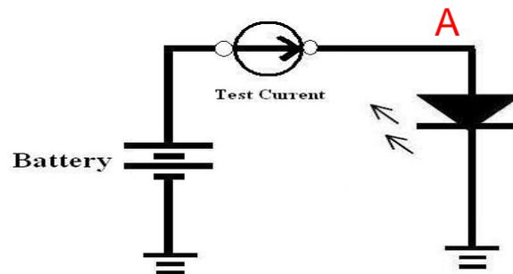
圖十一 不加穩流 IC 時測試線路圖
