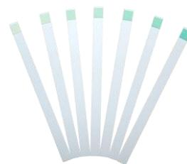
用 PVC 作为试纸载体,使用自带干燥剂铝筒包装,满足使用方便与储存的双重要求。
