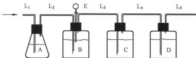
图 A.1  $\text{ClO}_2$  发生吸收装置图
