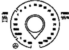
位置 1, 10 和 100 表示电子手轮在内部反馈  $x4$  的因子上施加的乘数因子。
