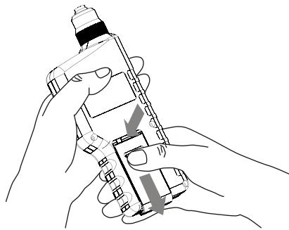
▶ 将9V电池正确的放入电池夹内，注意电池的极性，然后合上电池门，如下图：
