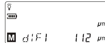
▶ 将探头置于被测件，轻压探头进行测量，提起探头并响一声“嘀”，LCD屏幕显示前一个值与当前值之差值的绝对值，LCD屏幕显示如下图所示：
