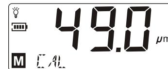
选择厚度在45~55间的标准片，按“▲”或“▼”键修改其显示值，使显示值与标准片的标称厚度一致，再将标准片放在铁基上进行校准。
