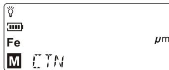
▶ 将探头置于被测件，轻压探头且不提起探头进行测量，测量过程中不响声，LCD屏幕连续显示测量结果，直至提起探头后，最后一个测量值自动记录于本机中，记录数据个数同时显示1，（当第二次连续测量结束时，测量个数则自动升级为2，以次类推，直到测量个数满15时，则不再递增），此时LCD屏幕显示如下图所示：
