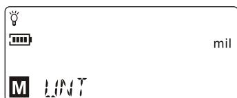
c. 若要准确地校准零点，须重复上述a、b步骤，以获得基体测量值小于 $1\mu\text{m}$ ，使测量精度提高。
