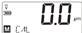
出现显示值0.0  $\mu\text{m}$ ，此时对铁基进行零点校准。
