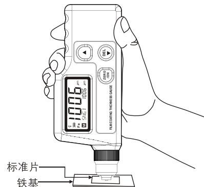
c. 在不提起探头的情况下，按“▲”或“▼”键修正读数后，校准已完成，可以开始测量了。
