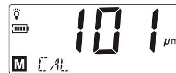
选择厚度在95~105间的标准片，按“▲”和“▼”键修改显示值，使显示值与标准片的标称厚度一致，再将标准片放在铁基上进行校准。
