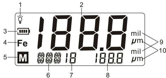
1. : 背光灯指示, 测量中7秒后无任何操作背光灯关闭。
