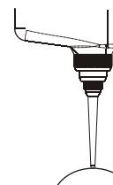
c. 拆下五金探头测量: 用于平坦物体表面测量, 以取得稳定数据, 如下图:
