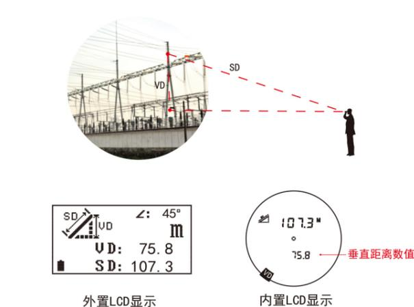
选择垂直距离测量模式时，内置LCD左下角会显示“VD”标识，将瞄准符号对准测量对象，短按电源键  $\odot$  进行测量，(等待测量中内置LCD左上角的“SD”0.5秒闪烁一次)；
