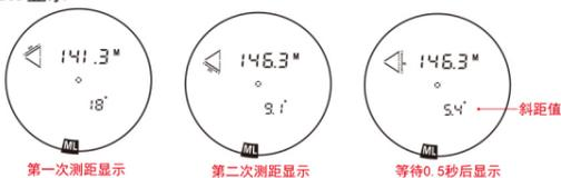
选择斜距模式时，内置LCD左下方会显示“ML”标识，将瞄准符号对准测量对象，短按电源键进行测量，（等待测量中内置LCD左上角的“SD”0.5秒闪烁一次）；当第一次测到距离时，“SD”停止闪烁；等待0.5秒自动进入第二测距界面，“SD”重新闪烁；当第二次测到距离时，“SD”停止闪烁，等待0.5秒后显示斜距值
