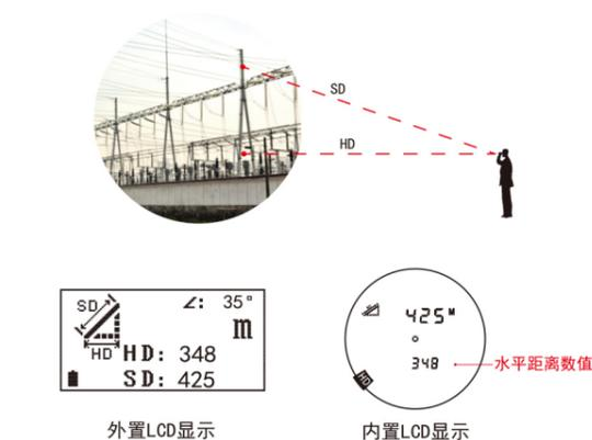
选择水平距离测量模式时，内置LCD左下角会显示“HD”标识，将瞄准符号对准测量对象，短按电源键  $\odot$  进行测量，(等待测量中内置LCD左上角的“SD”0.5秒闪烁一次)；
