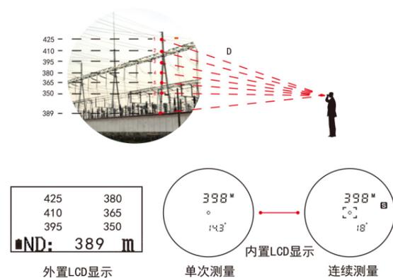
单次测量：短按电源键  $\odot$  就可启动单次测距。
