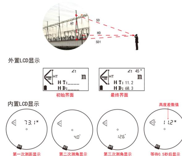
选择高度差测量模式时，内置LCD右下方会显示“HT”标识，将瞄准符号对准测量对象，短按电源键  $\odot$  进行测量，(等待测量中内置LCD左上角会有符号闪烁提示)；
