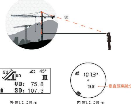
选择垂直距离测量模式时，内置LCD左下角会显示“VD”标识，将瞄准符号对准测量对象，短按电源键 $\downarrow$ 进行测量，（等待测量时内置LCD左上角的“SD”0.5秒闪烁一次）；当测到距离时，“SD”停止闪烁。
