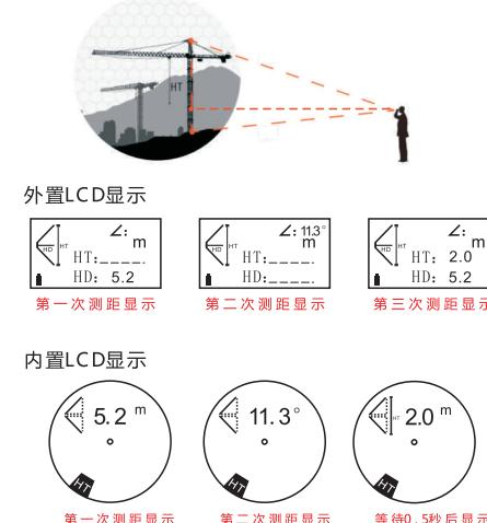
选择三点测高模式时，内置LCD左下角会显示“HT”标识，将瞄准符号对准测量对象，短按电源键 $\downarrow$ 进行测量；
