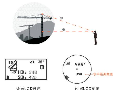
选择水平距离测量模式时，内置LCD左下角会显示“H D”标识，将瞄准符号对准测量对象，短按电源键 $\downarrow$ 进行测量，（等待测量中内置LCD左上角的“S D”0.5秒闪烁一次）；当测到距离时，“S D”停止闪烁。
