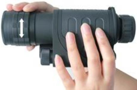
当目镜调节到最佳位置，透过目镜观察成像情况，同时旋转调节物镜焦距，直到成像清晰为止。
