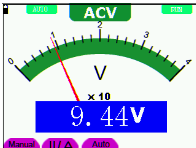
图 26: 交流电压测量界面
