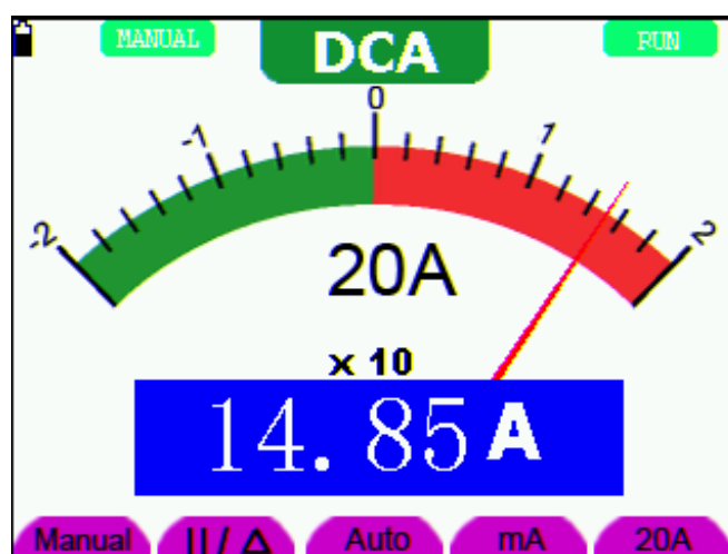
图 28: 直流电流20A量程测量界面
