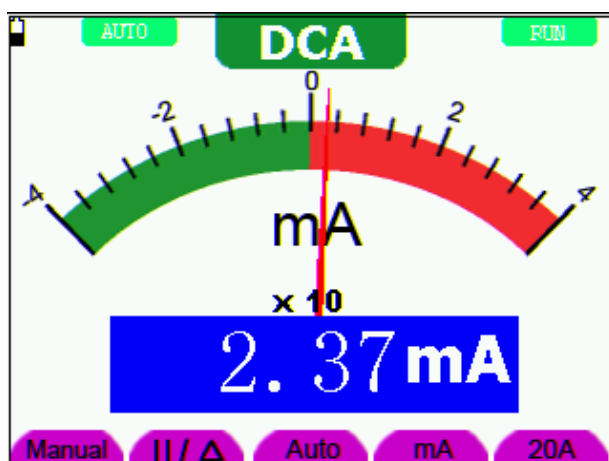
图 27: 直流电流测量界面
