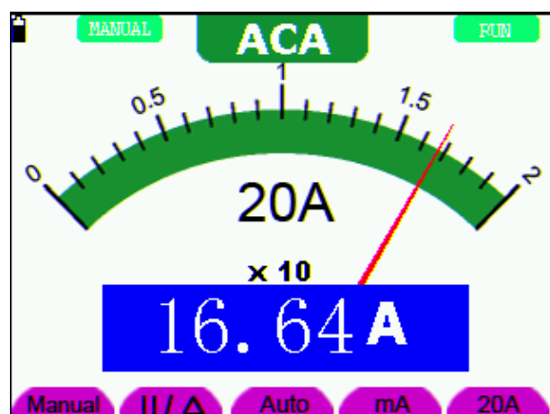
图 30: 交流电流20A测量界面
