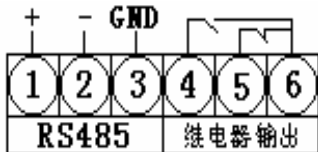
图 10a 扩展继电器输出和 RS485 输出 图 10b 扩展 D/A 输出
