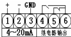
图 10a 扩展继电器输出和 RS485 输出 图 10b 扩展 D/A 输出
