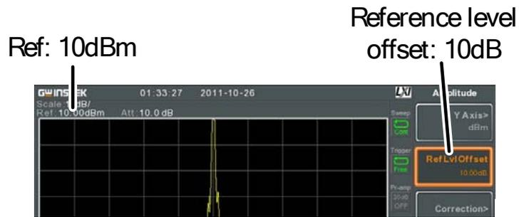
设置参考电平偏移后(offset: 10dB)
