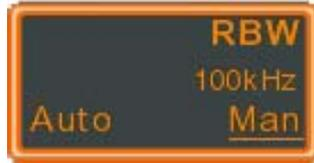
切换自动或手动状态。在手动模式时，需要手动编辑参数值。使用数字键盘输入新值或使用旋钮增加/减小当前值
