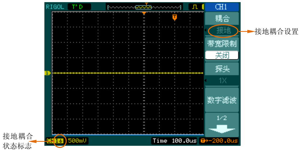
图 2-5 接地耦合设置
