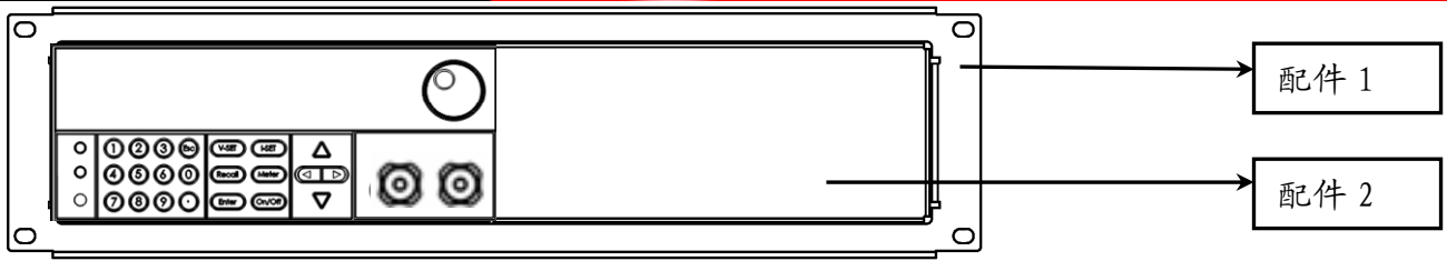
使用IT-E151将一台负载安装在标准的19寸仪器支架上的正面图
