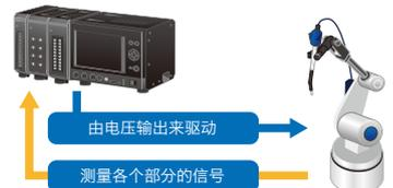
\* 被收录的信号可能在同一时间不被同时输出。每个通道的最大输出电流为10mA,单个模块的总输出电流最大为40mA。如果想驱动一些外部设备,需另外追加对应的功率放大装置。
