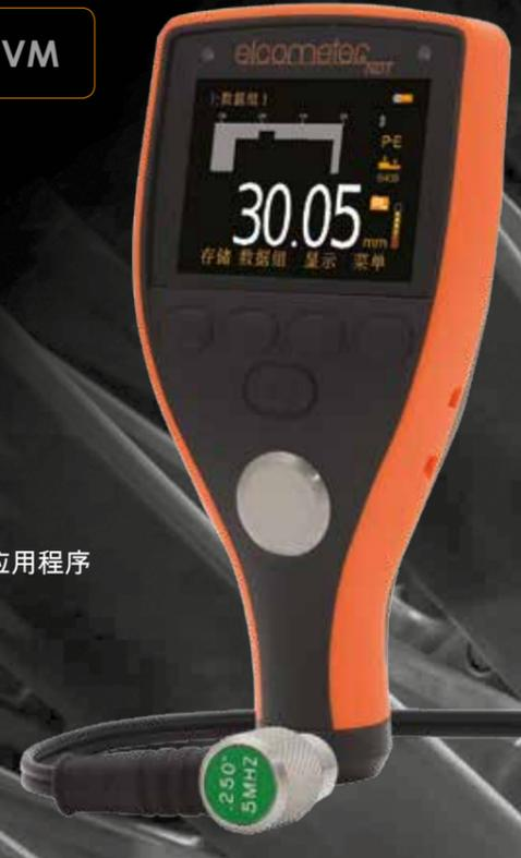
该MTG8是仪器系列内最高级的, 有必需用于几乎任何材料, 测量材料厚度和声速上的特性和功能和为广泛的应用。
