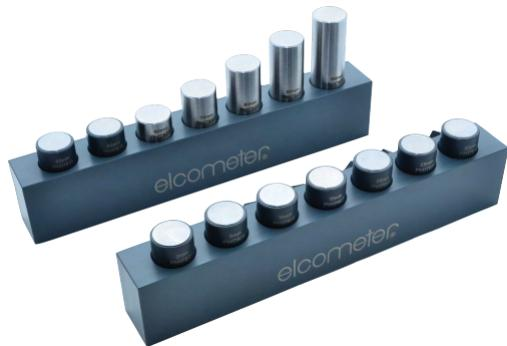
Les jeux de cales étalon et les cales individuelles sont livrés complets avec certificat de calibration.
