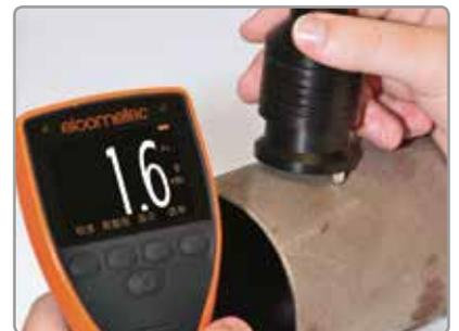
在平面或曲面\*\*上，整体式分体式探头测得的粗糙度高达500μm (20mils)
