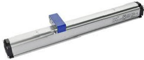
TCP 系列磁致伸缩位移传感器采用非接触式磁致伸缩测量技术。此技术能提供高精度、直接和绝对值的位移输出。非接触式设计不但便于安装,而且能消除所有工作磨损而带来的误差。
