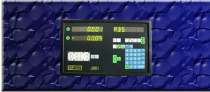
**用途:** 安装在各种床台上, 配合光栅尺为机床提供检测定位
