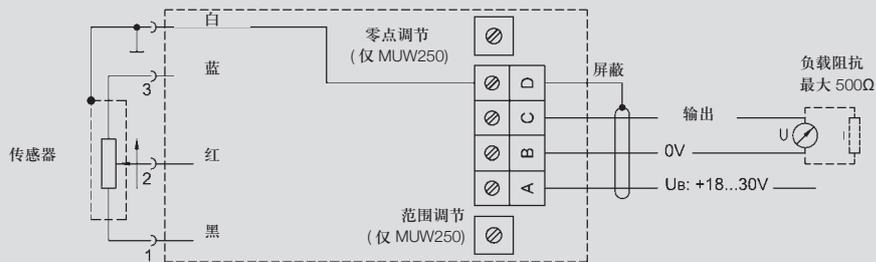
当传感器的拉杆（LWH系列）或滑块（TLH系列）从可变电阻的1端滑移至3端时，传感器的输出信号将逐渐增大；若需要传感器的输出信号作相反反应，则须将信号转换器插座盒中的终端1（黑色）与终端3（蓝色）对换。插座盒可在取出透明盖板后向外推出。
