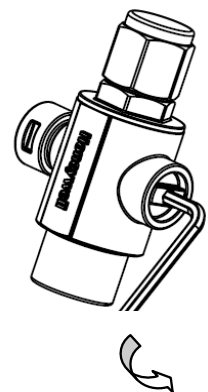
图8 逆时针旋转 排气阀开启
