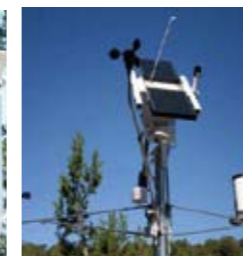
SolarTrak电子控制器和电池机箱
