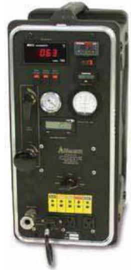
**方法 4 测定烟道气体中水的含量的概述：** 烟道气体是以等速率（小于 21 lpm）提取最少 600 升。水分会从采样气流中分离，并以体积或重量计量。
