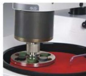
▶ 中心加压 必须同时夹持 3 或 6 个试样
