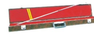
一等标准/二等标准铂铑10-铂热电偶 二等标准铂电阻温度计
