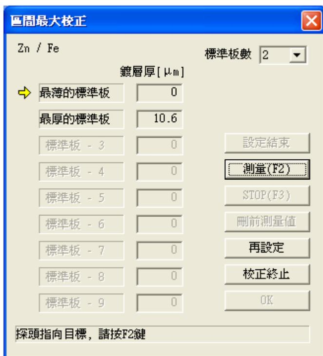
图 5-21 「区间最大校正」的对话框 (最薄的标准片测定)
