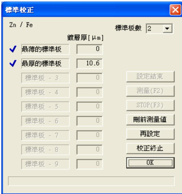
图 5-5 「标准校正」(标准片测定终了) 的对话框
