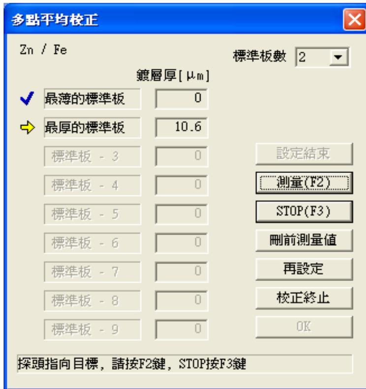
图 5-10 「多点平均校正」(最厚的标准片测定) 的对话框
