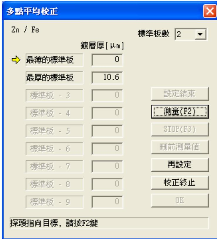
图 5-9 「多点平均校正」(最薄的标准片测定) 的对话框
