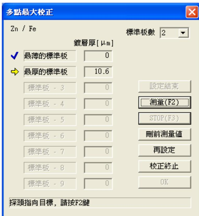
图 5-17 「多点最大校正」(最厚标准片测定) 的对话框
