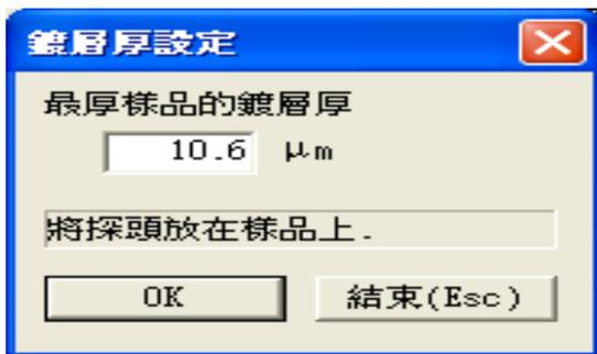
图 10-9 「膜厚设定」(最厚样品的膜厚)对话框
