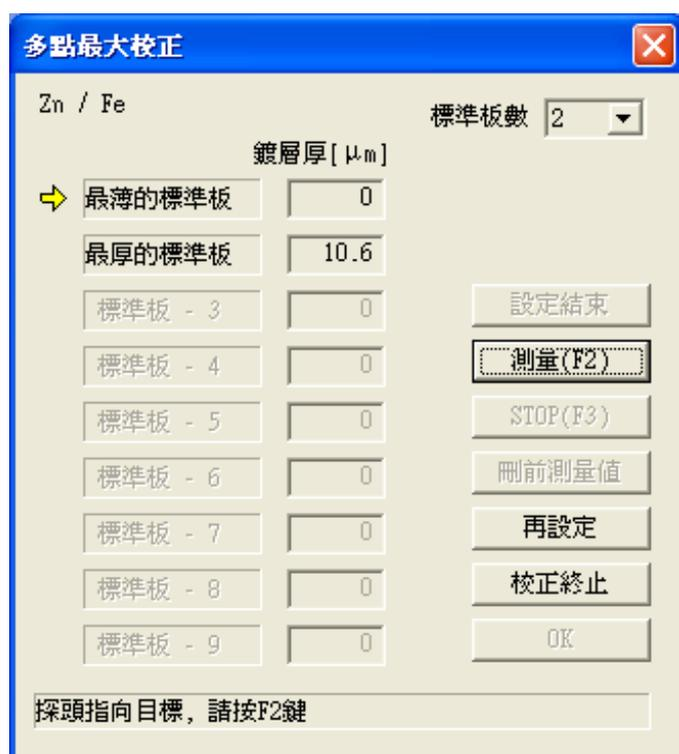
图 5-16 「多点最大校正」(最薄标准片测定) 的对话框
