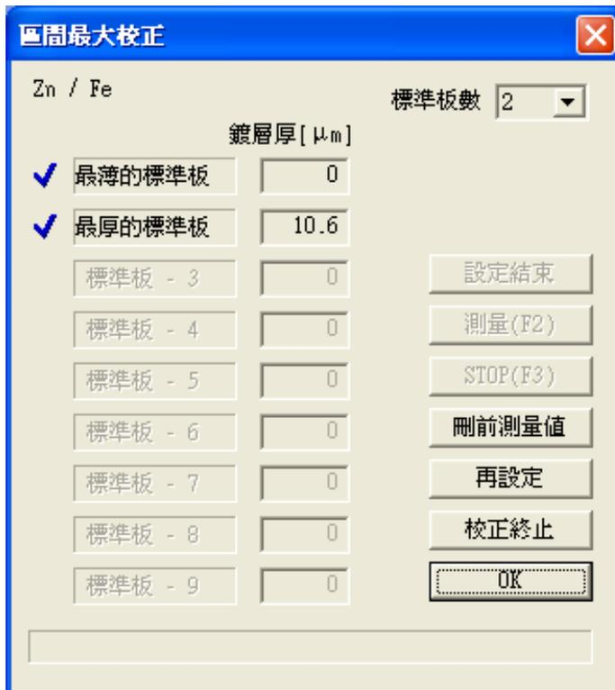
图 5-25 「区间最大校正」的对话框 (标准片测定终了)
