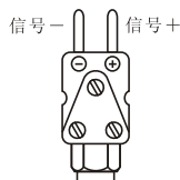
温度传感器两芯接线 功能定义
