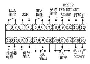
当仪表的继电器控制交流接触器、电磁阀等电感性负载时,容易产生电火花,对仪表有干扰,在继电器的控制端并联RC能有效地减小干扰,并能延长继电器的使用寿命,并联电阻用0.5瓦100欧,电容用1000V/0.033u。并且接触器的电源不能从仪表电源端子处(A、B点)引出,且尽量不与仪表电源同一线路,避免接触器动作时干扰仪表
