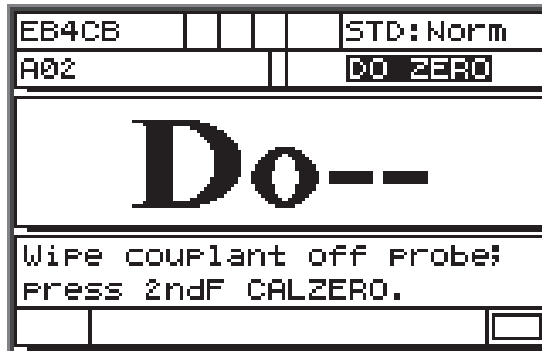
图 5-2 未知声速材料的零位补偿屏幕
