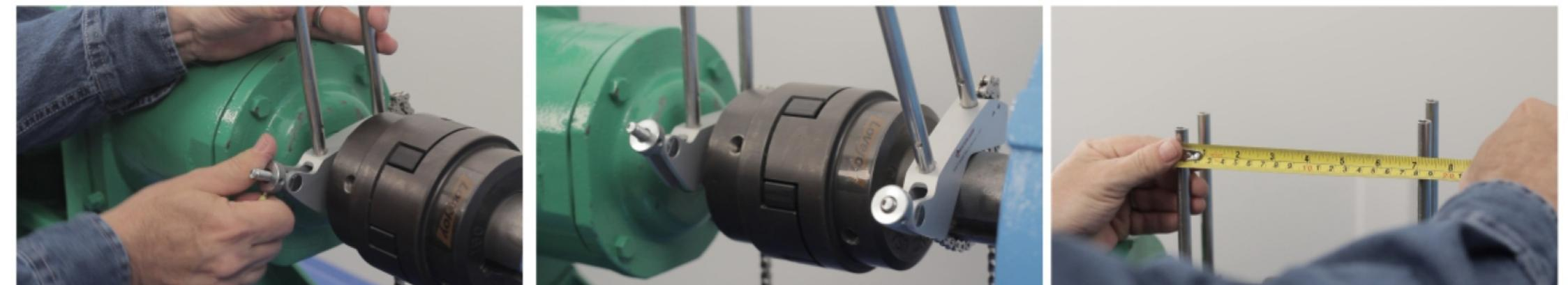
step 4 选择适合的杆件，杆件从杆座伸出的长度应略短于V型夹具的间距。
