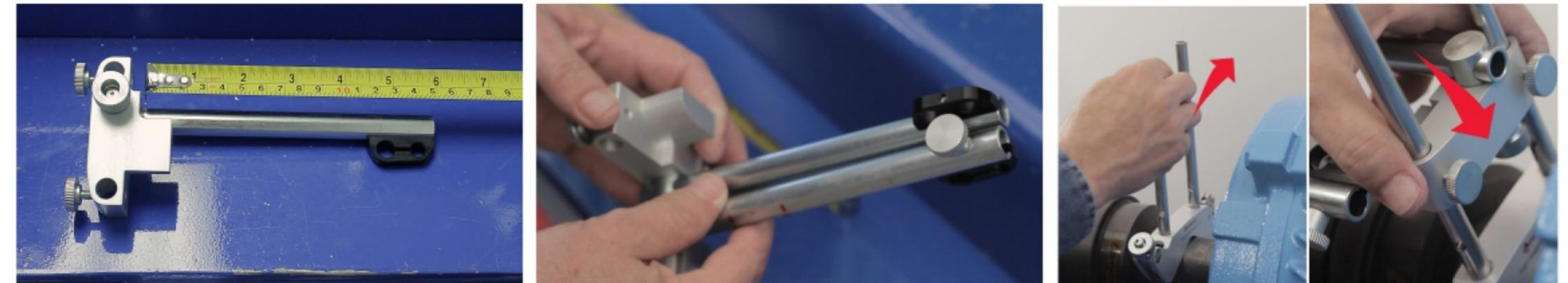
step 7 旋转V型夹具，使杆件表针孔正对杆座顶面，使用扳手工具紧固第二块V型夹具，确保两侧V型夹具完全紧固。
