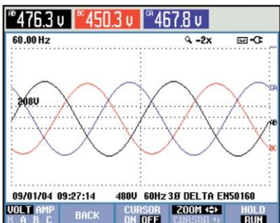
为进一步获得信息，他切换到 Voltz/Amps/Hertz 屏幕的数值读数，此处的电流读数更高而且仍未平衡。
